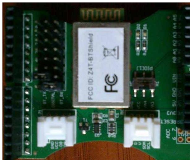
Figura 2. Bluetooth del Arduino® Mega ADK. Fuente: autores.
