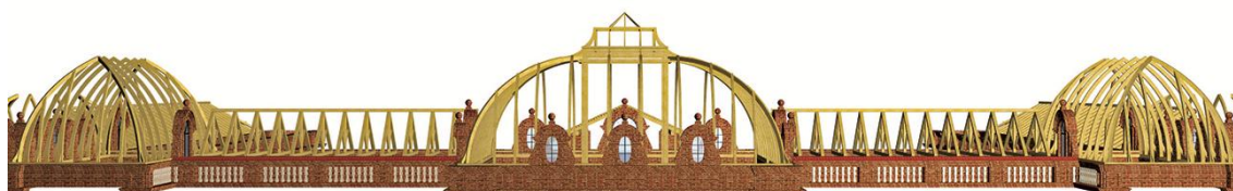
Imagen 14: Estructura de madera de las cubiertas.
