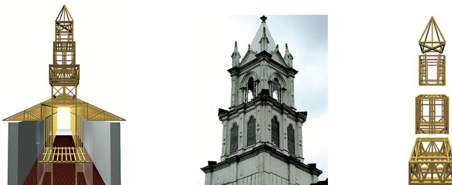
Imagen 21: Estructura y detalles de la torre de la iglesia.
