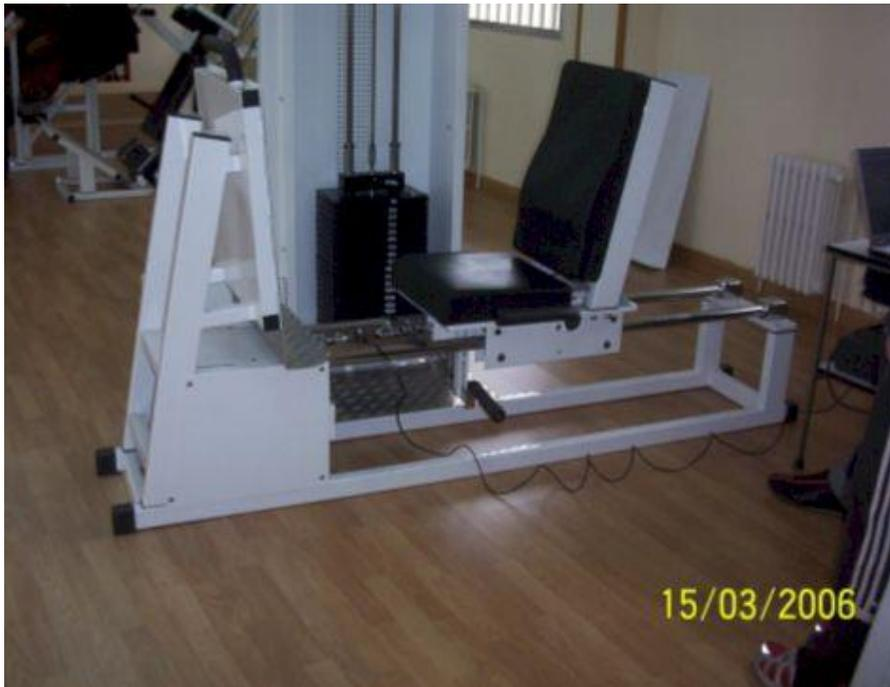
Figura 1. Prensa horizontal para medir la FIM de los músculos extensores de rodilla.
