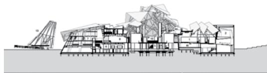
Figura 4. Secciones transversal y longitudinal del Biomuseo. Cortesía de Gehry Partners, LLP
