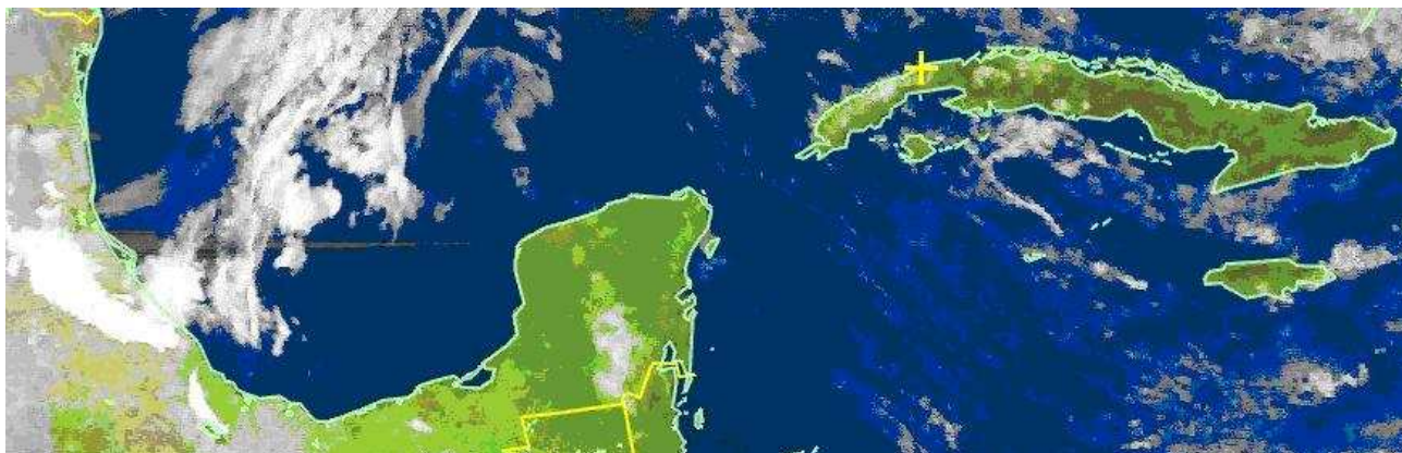
Fig. 19 Imagen procesada obtenida en la frecuencia de 137.9125 MHz (Satélite NOAA-18) con la antena Moxon después de optimizarla con las dimensiones dadas por el software CST.
