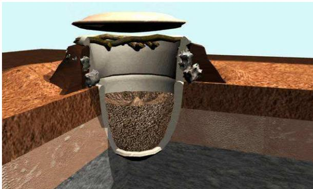
Figura 7. Estructura de un silo.
