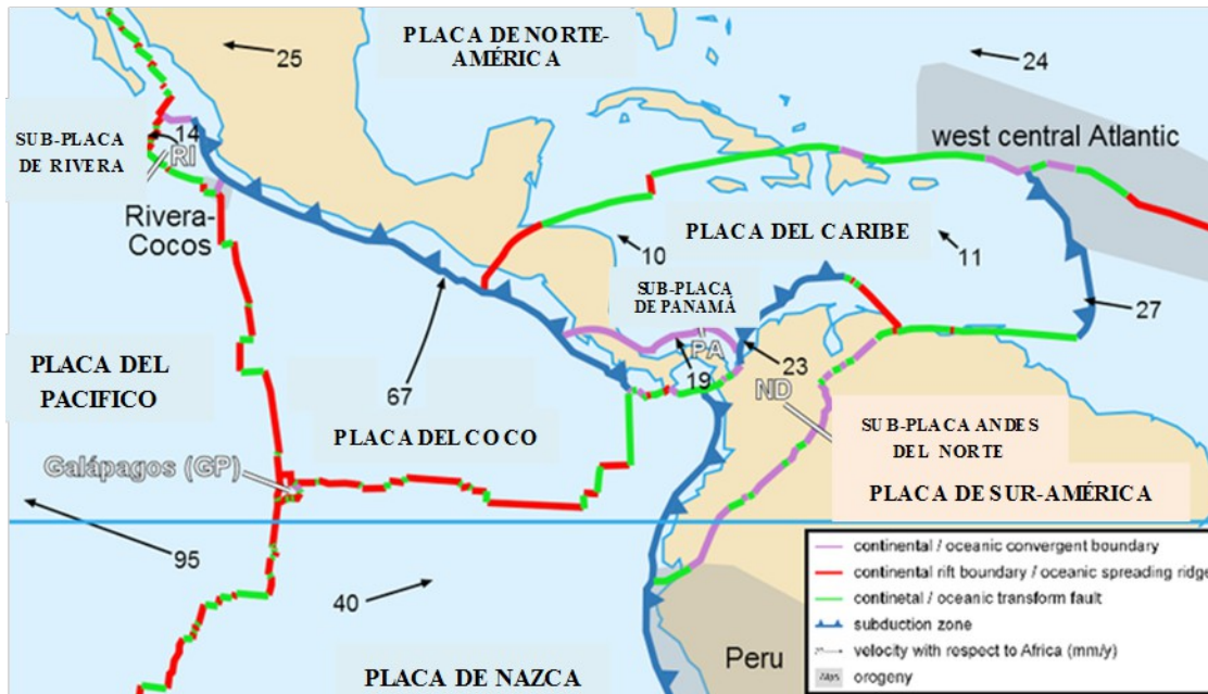
Figura 3: Fragmentación de placas y sub-placas, tipo de bordes y localización sismotectónica de la región de la zona de estudio en y alrededor del Istmo de Panamá.
