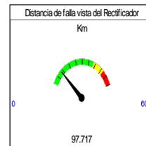
Fig. 15. Distancia de falla detectada por el relé.
