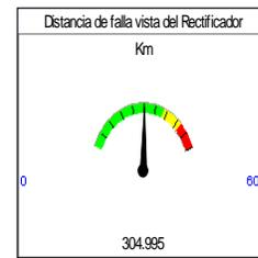
Fig. 21. Distancia de falla detectada por el relé.
