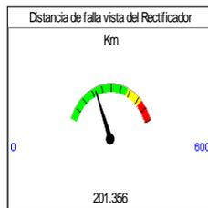
Fig. 17. Distancia de falla detectada por el relé.
