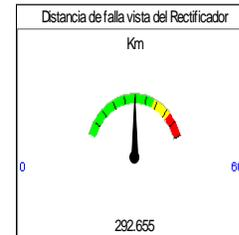
Fig. 22. Distancia de falla detectada por el relé.
