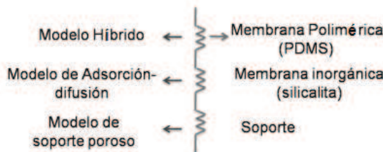
Fig. 2. Esquema del modelo de resistencia en serie para la membrana compuesta por capas PDMS-Silicalita.
