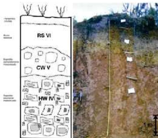
Figura 2. Perfil de meteorización en rocas volcánicas (P1)
