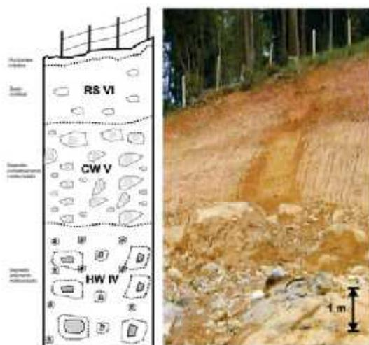
Figura 3. Perfil de meteorización en rocas plutónicas (P2)
