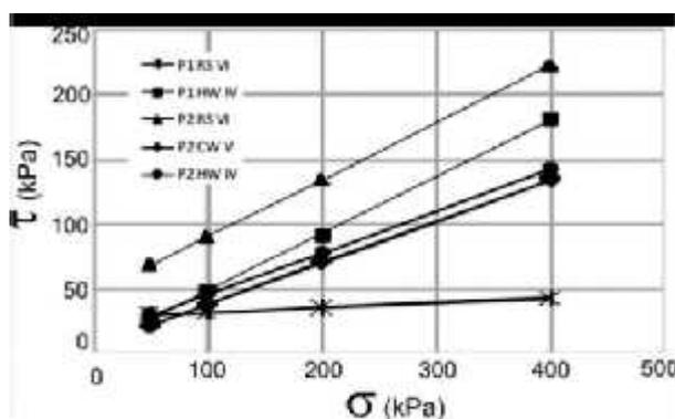
**Figura 10.** Relación entre el esfuerzo normal aplicado y la resistencia al cortante.
