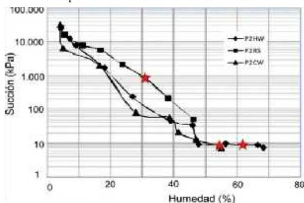
**Figura 9.** Curvas características Humedad vs succión del perfil de meteorización en rocas plutónicas. La estrella sobre cada curva corresponde a la humedad natural de la muestra.
