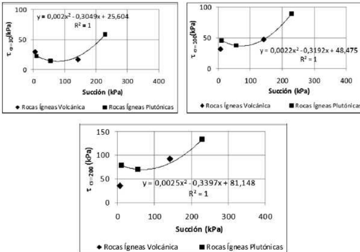
Figura 15. Relación entre la succión y la resistencia al corte (τ) para esfuerzo vertical de 30, 100 y 200 kPa
