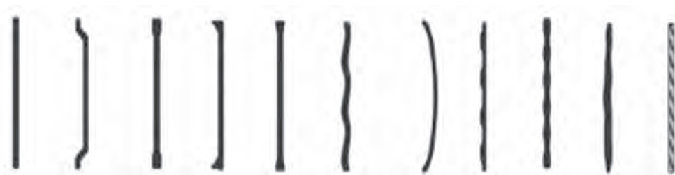
Figura 1. Tipos de fibras de acero, comercialmente disponibles [36] y [37]. De izquierda a derecha, de acuerdo con los nombres conocidos comercialmente: rectas (lisas), extremos en ganchos, extremos en palas, extremos en perillas, extremos cónicos, onduladas (corrugadas), en forma de arcos, dentadas, superficie indentada, irregulares y torsionadas.
