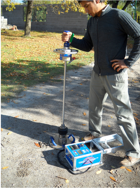
Figura 1. Deflectómetro Liviano de Impacto (Fuente: TERRATEST)
