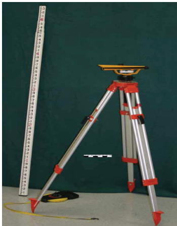
Figura 3. Nivel y mira topográfica
