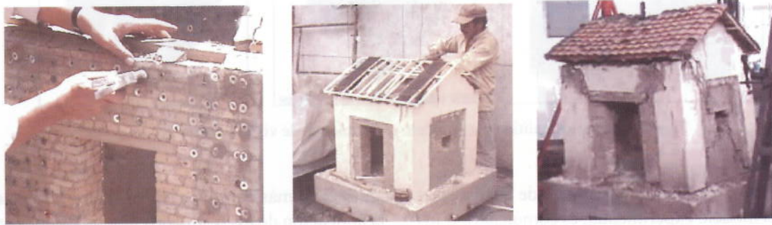
Figura 2. Modelación física para cargas sísmicas de vivienda en tierra a escala 1:5 [11]
