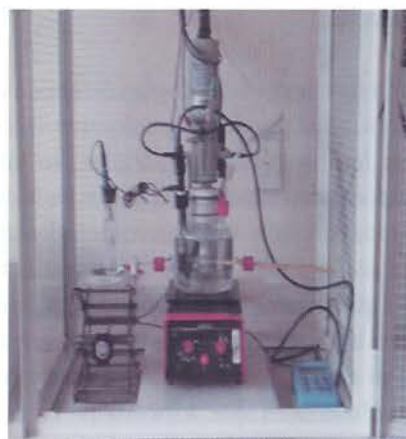
Figura 1. Montaje empleado para pruebas electroquímicas en el RCE.
