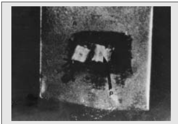
FIGURA 2. MONTAJE SOBRE PAPEL DE ALUMINIO (A) DEL CORTE GRUESO INCLUIDO EN PARAFINA (P), DE 40 MICRAS DE ESPESOR. RESULTADOS FAVORABLES PARA LA OBSERVACIÓN AL SEM.
