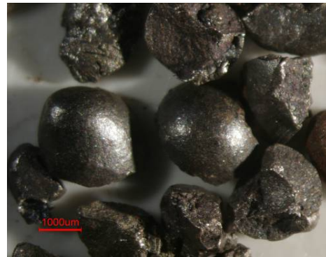
Figura 3. Morfología de las partículas de acero.
