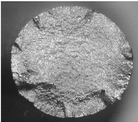
Figura 7. Superficie de fractura de la probeta chorreada con partículas de alúmina.
