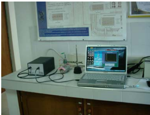
Figura 7. Esquema del prototipo de sistema potenciostatico.
