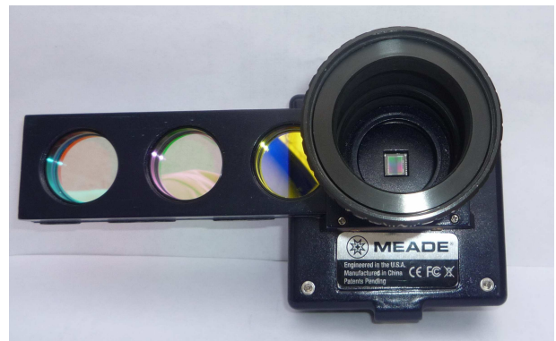
Figura 3. Cámara digital utilizada en el proyecto con los filtros de colores ubicados en la regleta central.
