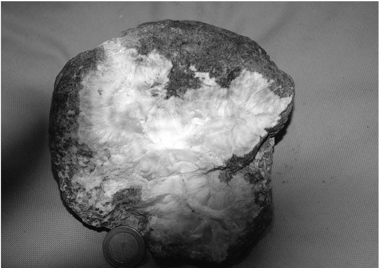
Figura 9. Una pieza como esta no se selecciona, sino que se pesa y clasifica como de alta calidad, incluyendo el material carbonáceo no aprovechable. Mina Vieja.
