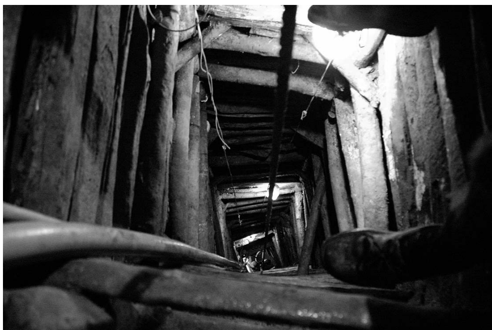
Figura 4. Las labores comienzan con un pozo de reconocimiento que más tarde se convertirá en la única vía de acceso a las explotaciones.
