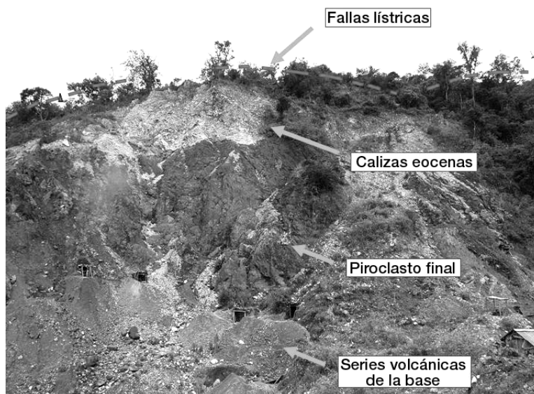
Figura 6. Frente de la explotación que muestra los cuerpos geológicos presentes en las explotaciones mineras
