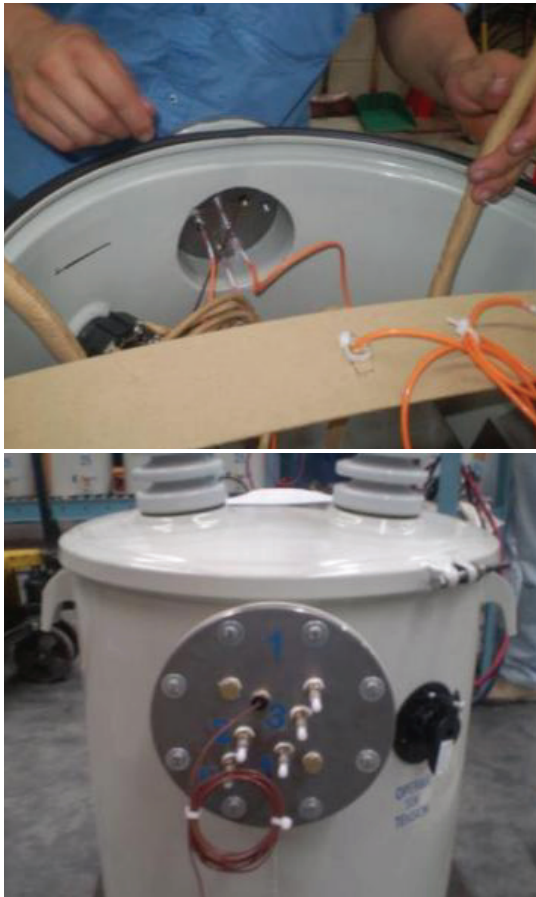
Figura 3. Instrumentación de los transformadores.
