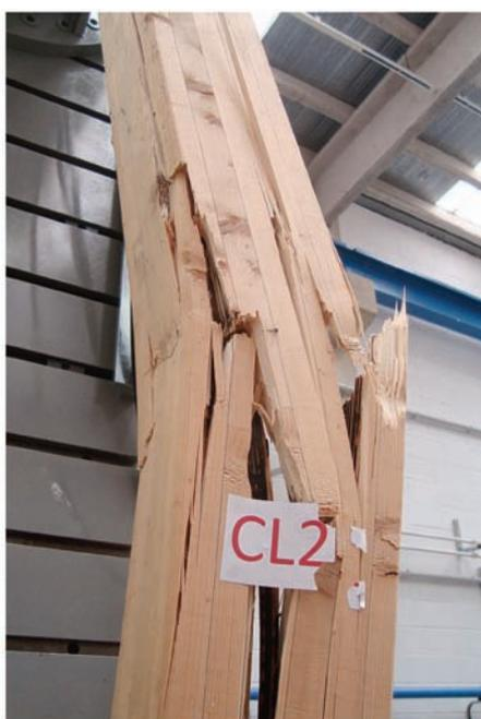
**Figura 16.** Forma de fallo característica de las probetas esbeltas sometidas a compresión.
