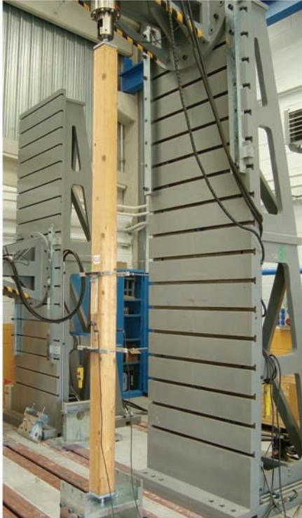
**Figura 10.** Dispositivo para el ensayo de compresión.
