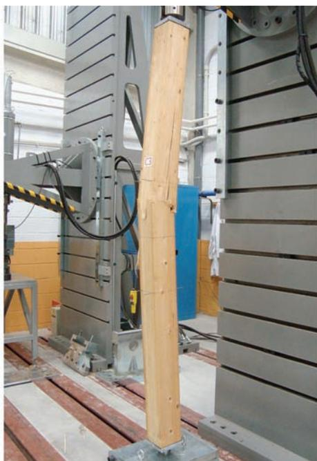
**Figura 15.** Forma de fallo característica de las probetas esbeltas sometidas a compresión.
