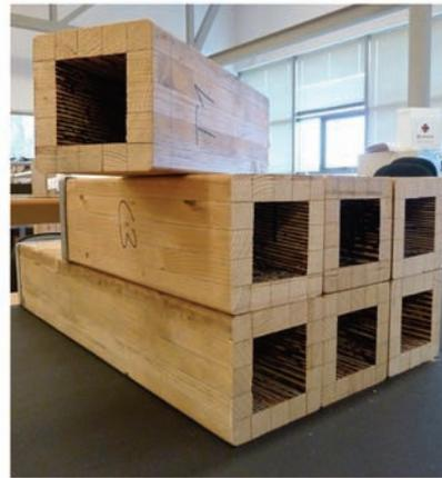
**Figura 5.** Barras de sección hueca.
