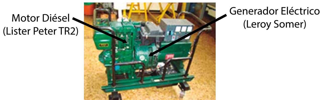
Figura 4. Planta de potencia que opera con mezclas de biodiésel de higuera.
