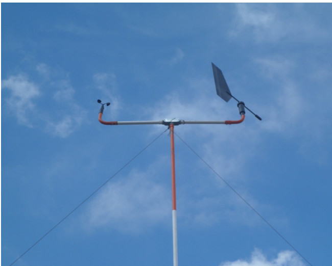
Figura 12. Instalación de los sensores construidos.
