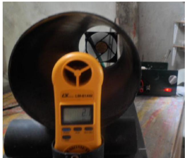
Figura 3. Anemómetro patrón ( LM-81AM ) y túnel de viento generado por ventilador.
