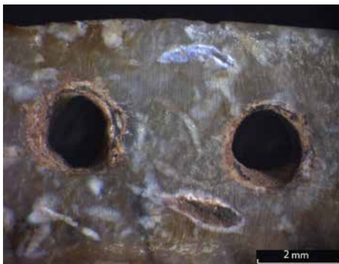
Fig. 10 Perforaciones, vistas desde la cara superior
