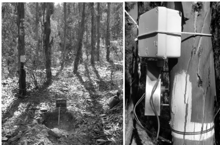
Fotografía 1. Izda.: punto de muestreo del suelo junto a un árbol con dendrómetro electrónico. Dcha.: de abajo hacia arriba, dendrómetro de banda, dendrómetro electrónico, y la caja que protege el sistema de almacenamiento de datos (datalogger)
