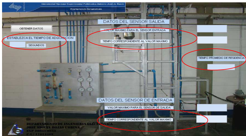
FIGURA 11. Captura de pantalla de la interfaz gráfica, se observan el campo de entrada para el tiempo de adquisición y los campos de salida para el tiempo correspondiente a cada uno de los sensores y el tiempo de residencia en el lazo de regeneración (enmarcados por una elipse roja) [6]
