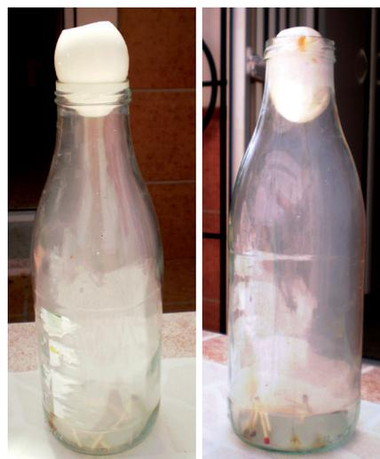
**Figura 5.** Ilustración del experimento clásico en el que un huevo cocido se introduce en una botella al apagarse unas cerillas, por efecto de la presión atmosférica.
