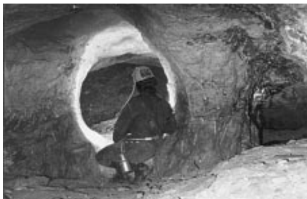
Cruce de galerías en la HPC5 (Huete, Cuenca). Obsérvese la acumulación de estériles sobre el suelo, así como la veta de mineral sobre la galería que parte a nuestra derecha. (Foto: José Martínez Hernández)
