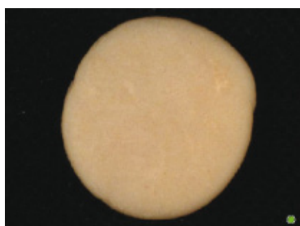
FIGURA 11 GRUPO 4: PULIDO. DESPUÉS DEL TERMOCICLADO Y DE HABER SIDO SUMERGIDO EN LOS LÍQUIDOS
