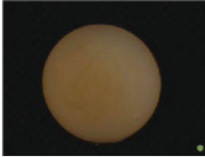
FIGURA 3 GRUPO 1: NO PULIDO. DESPUÉS DEL TERMOCICLADO Y DE HABER SIDO SUMERGIDO EN LOS LÍQUIDOS
