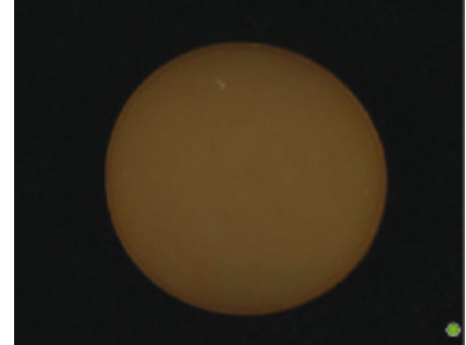
FIGURA 6 GRUPO 2: NO PULIDO. DESPUÉS DEL TERMOCICLADO Y DE HABER SIDO SUMERGIDO EN LOS LÍQUIDOS
