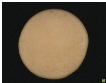
FIGURA 12 GRUPO 4: PULIDO. DESPUÉS DEL TERMOCICLADO Y DE HABER SIDO SUMERGIDO EN LOS LÍQUIDOS
