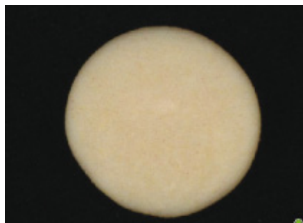
FIGURA 11 GRUPO 4: PULIDO. DESPUÉS DEL TERMOCICLADO Y DE HABER SIDO SUMERGIDO EN LOS LÍQUIDOS
