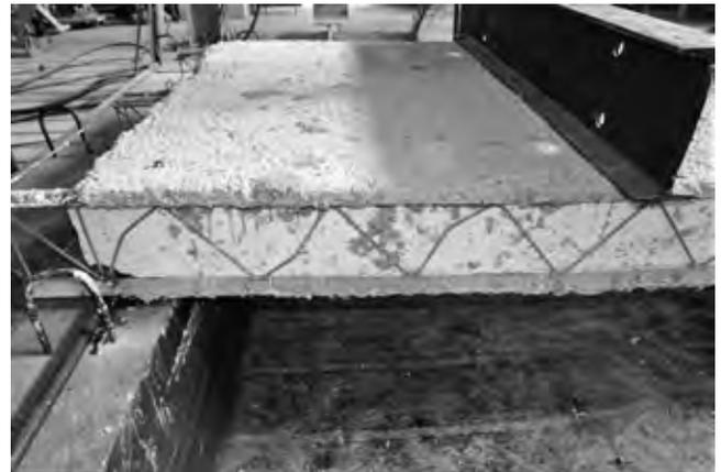
Figura 6. Pandeo de las diagonales o celosías de las losas LT1 y LT4
