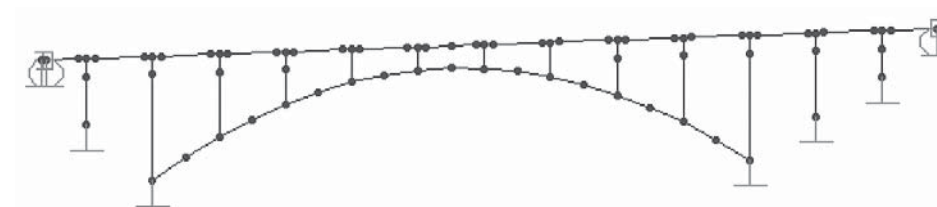
Figura 10. Modelo analítico del puente VG
