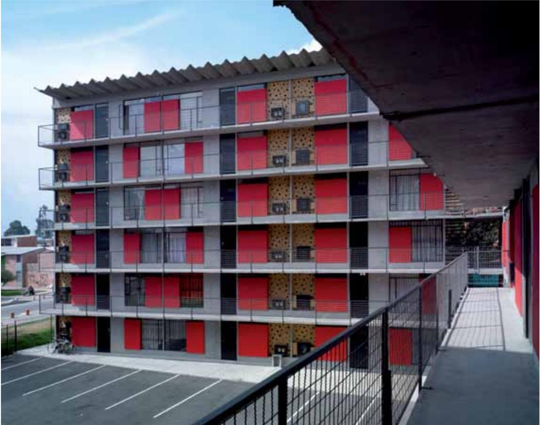
Figura 1. La circulación horizontal y los accesos a los apartamentos son organizados mediante galerías abiertas o balcones comunales.
