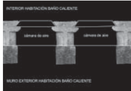
C/ Carrera de las Monjas, 3. Sistema de concameratio documentado en una de las salas calefactadas de las termas de la villa
