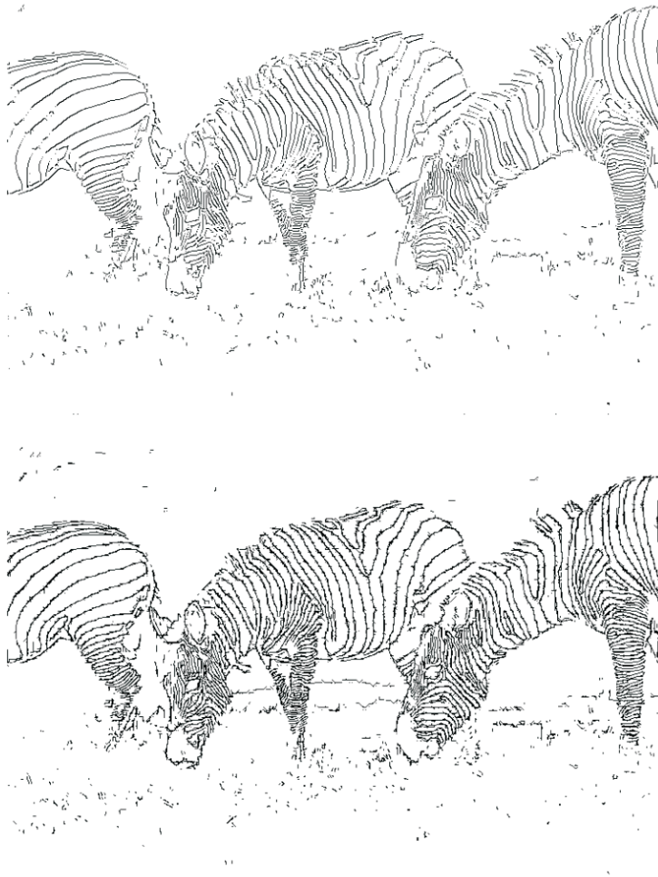
FIGURA 12. a. Bordes Canny (arriba). b. Bordes método propuesto (abajo).
