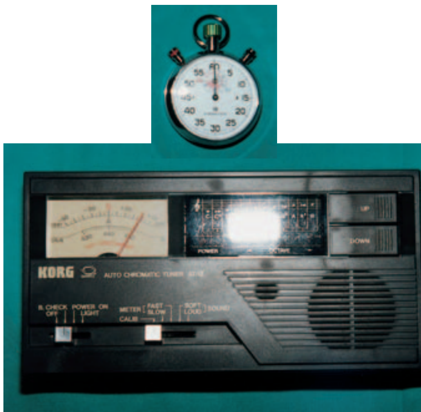
Figura 9.- Cronómetro (modelo Superwatch) con el que medimos los tiempos máximos de fonación de [s] y [a]. Afinador autocromático de cuarzo (KEIO Electronic Lab, modelo KORC AT-12) que registraba la nota más grave y la más aguda de la extensión vocal del docente.
