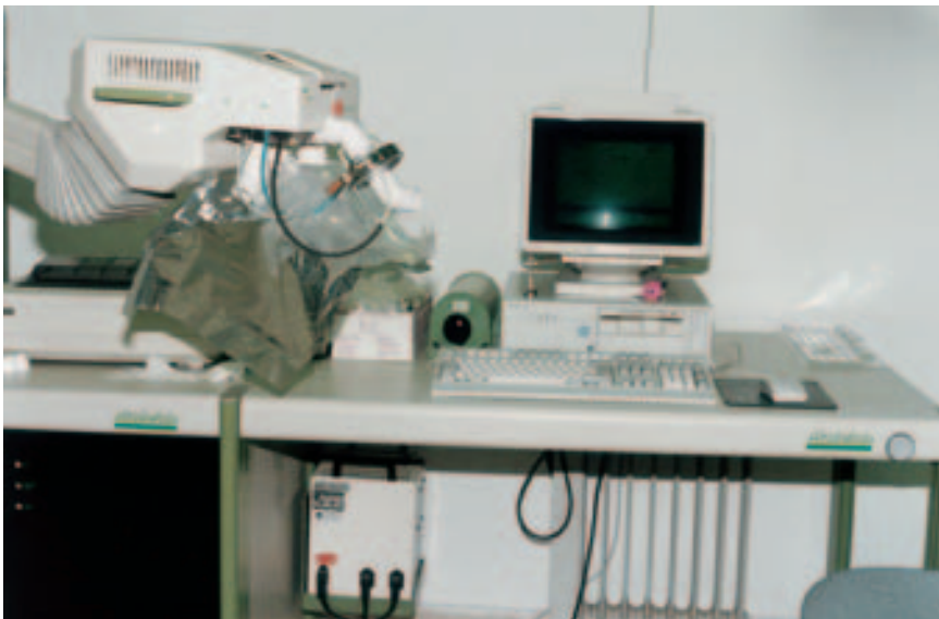
Figura 8.- Espirómetro digital (JAERGER, modelo Master-Lab V 2.13) con el que realizamos las pruebas funcionales pulmonares: volúmenes y flujos de aire.
