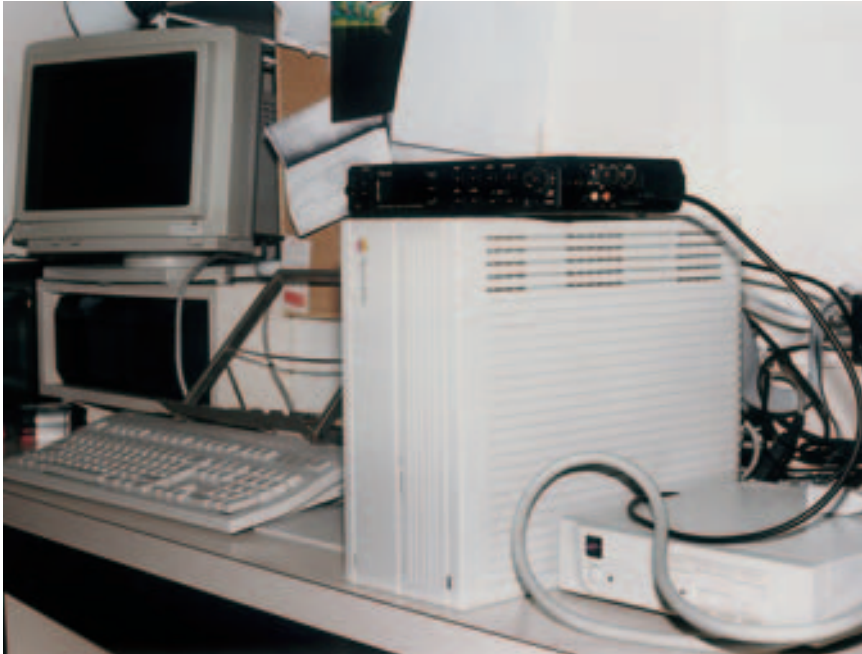
Figura 10.- Instrumental del análisis digital de la voz. Ordenador personal Macintosh II-CI (Apple Computer) y programa SoundScope 1.0 (GW Instruments). Previamente se habían grabado las muestras de voz en un DAT (TEAC modelo DA-P20) con un micrófono (AKG modelo D-190).
