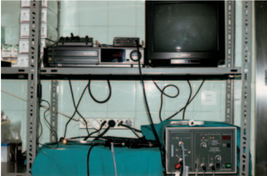
Figura 7.- Instrumental de vídeo-laringoestroboscopia: fuente de luz continua y de luz estroboscópica (STORZ, modelo 8010), telelarinoscopio de 70° (STORZ, modelo 8706 CJ), cámara de vídeo (ELMO CCD, EM-103 PAL), micrófono Electrostático electroreto (ECM-153) y pre-amplificador (Musicson Micromixer, modelo Wan 290), vídeo (SONY, modelo SLV-225) y monitor (SONY, modelo Trinitron KV-M1420-E).
