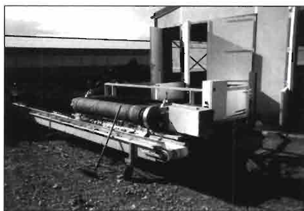
Sistema de descarga de las cintas a una cinta transversal.
