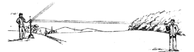
FIGURA 2. Fotófono construido por A G Bell según un dibujo de la época (encima) y esquemas hechos por el propio Bell, quien intentaba transmitir la voz utilizando un haz modulado de luz.
