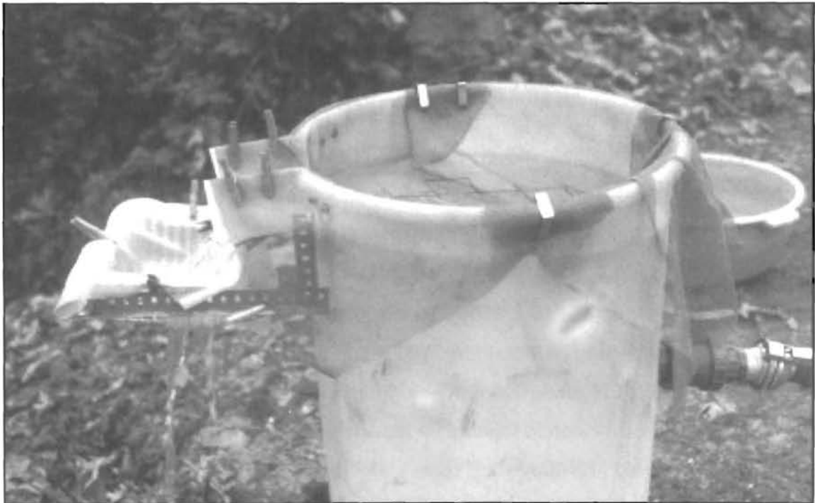
Foto 3: Máquina de flotación fabricada con un contenedor de plástico.
