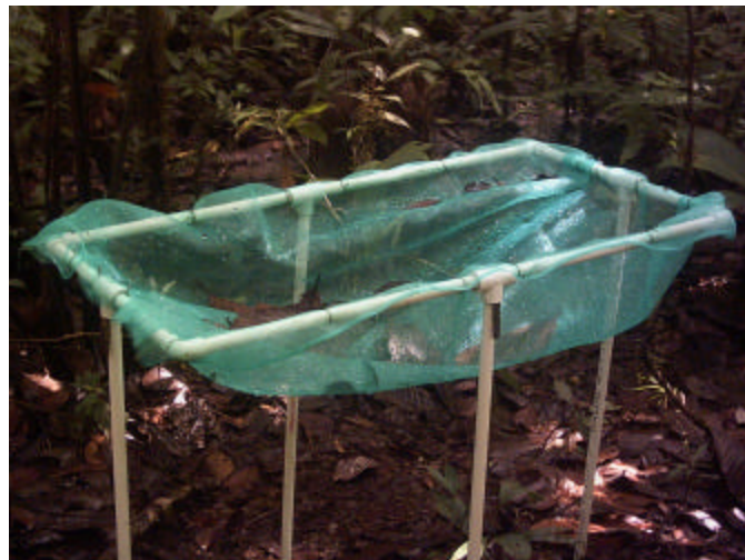
Figura 2. Fotografía de colectores de hojarasca instalados en el bosque de Salero.
