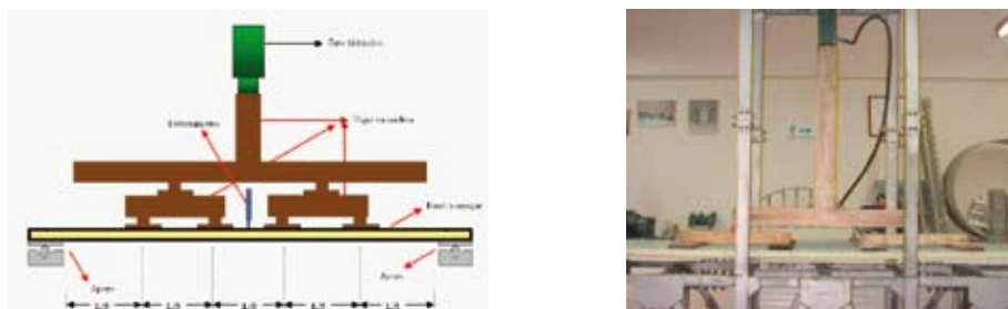
Figura 11. Esquema del ensayo de flexión en paneles de muro Monowall
