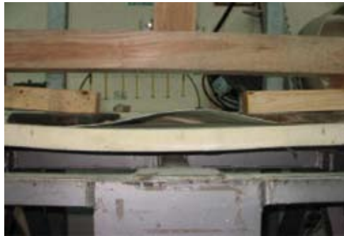
Figura 12. Mecanismo de falla de los paneles a flexión
