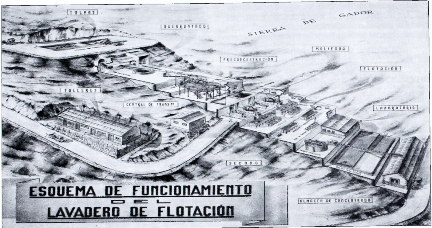
Esquema de funcionamiento de lavadero de flotación. Vid. el esquema que apareció en Farua nº 3/2000.
