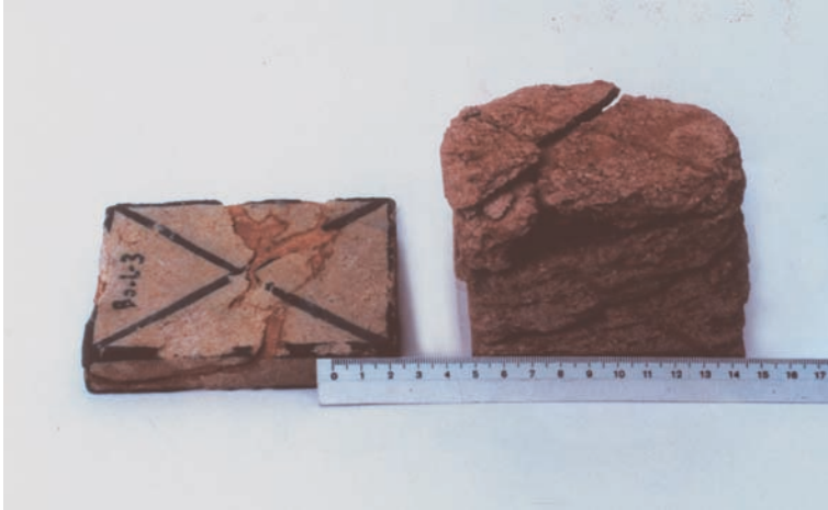
Fotografía 6- Aspecto de dos muestras de piedra de las canteras de Boñar (izquierda) y Sepúlveda (derecha) finalizado el ensayo de envejecimiento artificial acelerado de cristalización de sales. Ruptura de las probetas a favor de los planos débiles.
