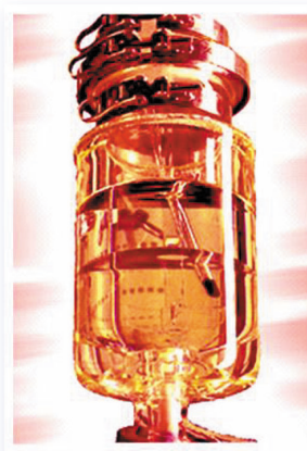
Figura 4. Fotografía de un reactor del proceso BASIL. El Líquido Iónico se separa del medio de reacción permitiendo la mejora del rendimiento de la reacción
