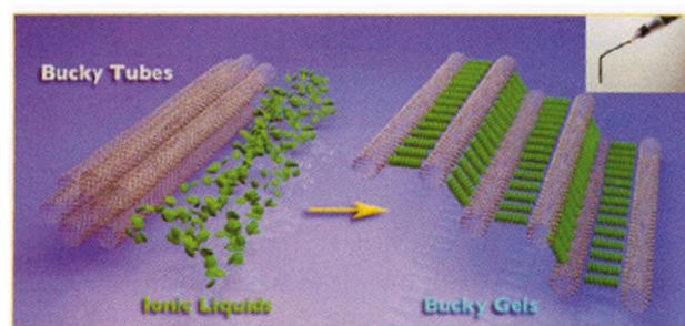
Figura 9. Esquema representativo de los geles obtenidos utilizando nanotubos de carbono y LIs
