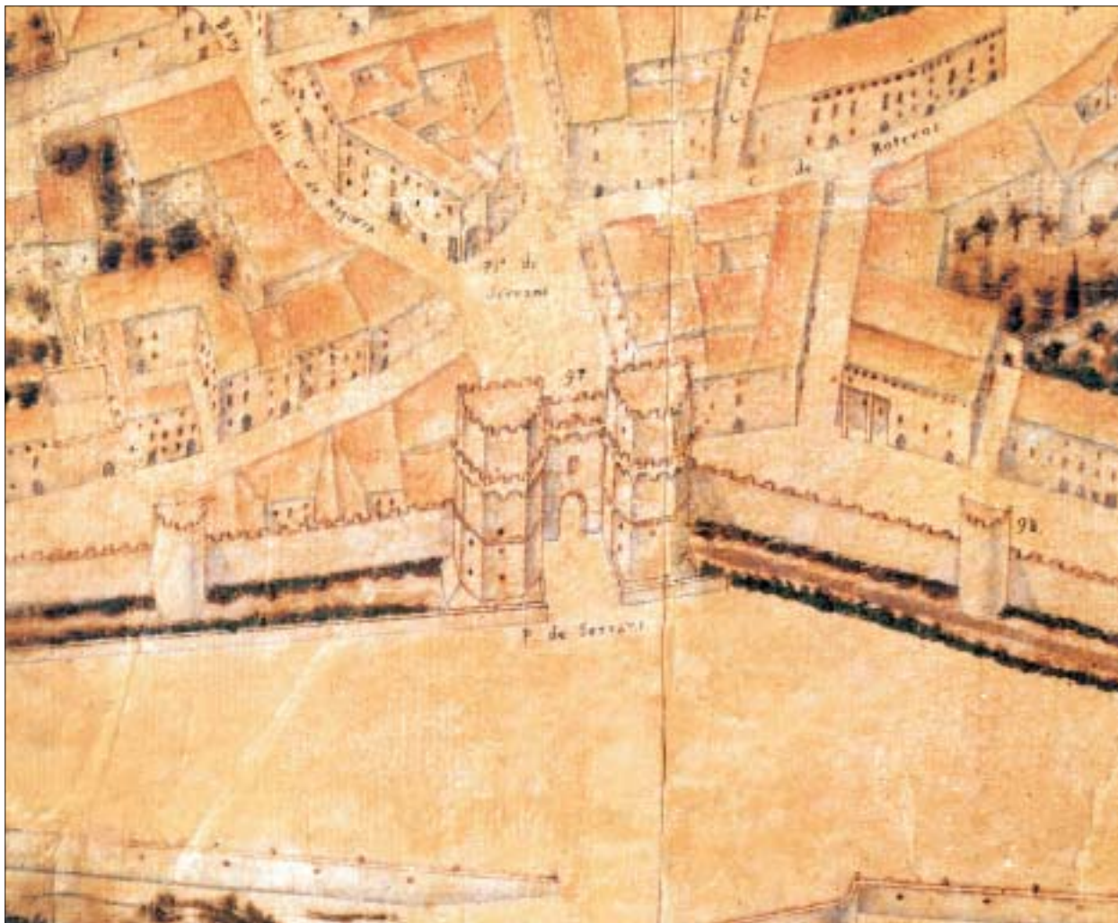
Fig. 5. EL PORTAL DE SERRANS (1398), CENTRO MONUMENTAL DE LA FACHADA SEPTENTRIONAL. La perspectiva de T. V. Tosca permite ver detalles como los taludes interiores, la barbacana y las almenas, así como el foso y la estudiada planta que convirtió la puerta en el principal emblema urbano ( Valentia Edetanorum... ichnographice delineata . Arxiu Històric de l'Ajuntament de València).
