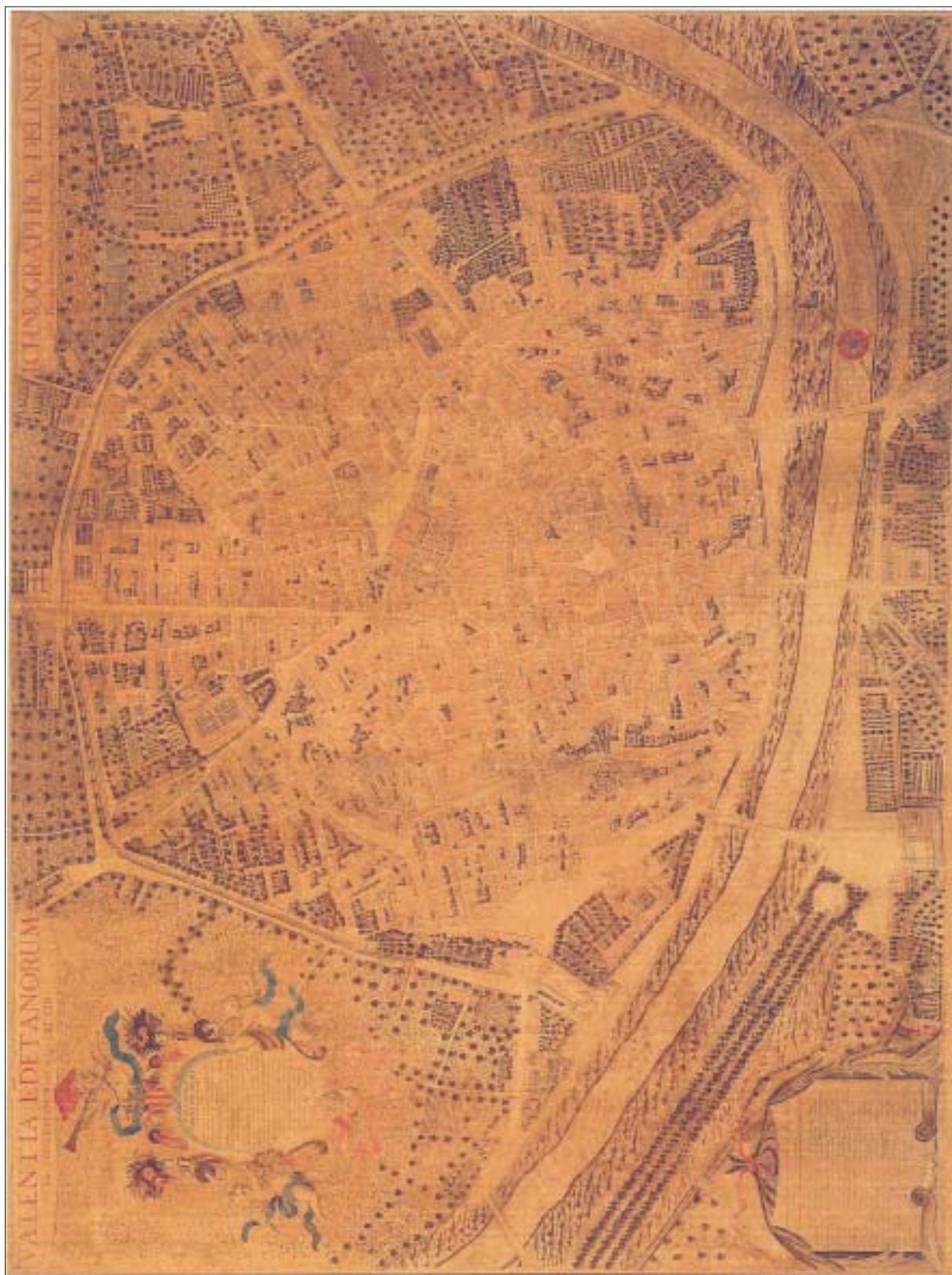
Fig. 3. EL PLANO DELINEADO POR T. V. TOSCA EN 1704. Encargo municipal realizado a una escala aproximada de 1/810. Sobre la planta ( ichtnographia ) incluye una representación tridimensional muy minuciosa. 203,5 × 267,5 cm. (Arxiu Històric de l'Ajuntament de València).
