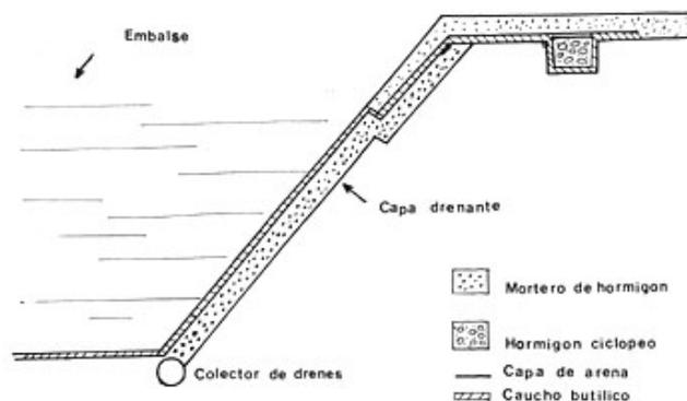
**GRÁFICO 1.** Esquema de la estructura del embalse de butilo. [36]
